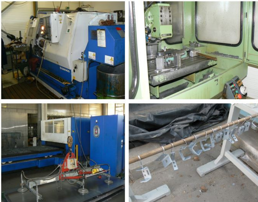
19. ábra: Az alkatrészek gyártásához felhasznált szerszámgépek: CNC eszterga, megmunkáló központ, lézeres lemezvágó és a lefestett profilok
