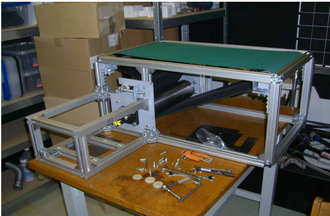
22. ábra: A merevített motortartó
