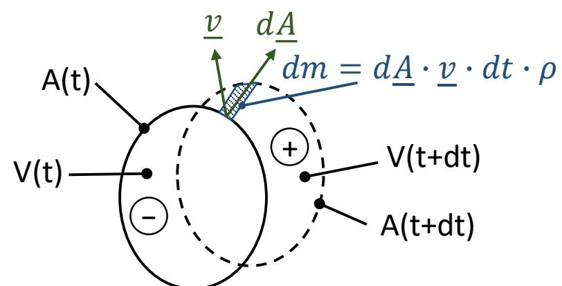
Mivel az áramlás itt stacioner:  $\frac{d}{dt} \int_V \rho \underline{v} dV = \int_A \underline{v} \rho \underline{v} d\underline{A}$
