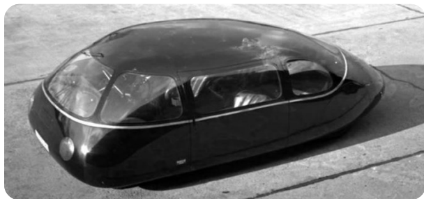
Karl Schlör áramvonalas autójának („Schlörwagen” 1939) az ellenállástényezője c_e=0,15 értékű volt ( v_{max}=84 mph)
