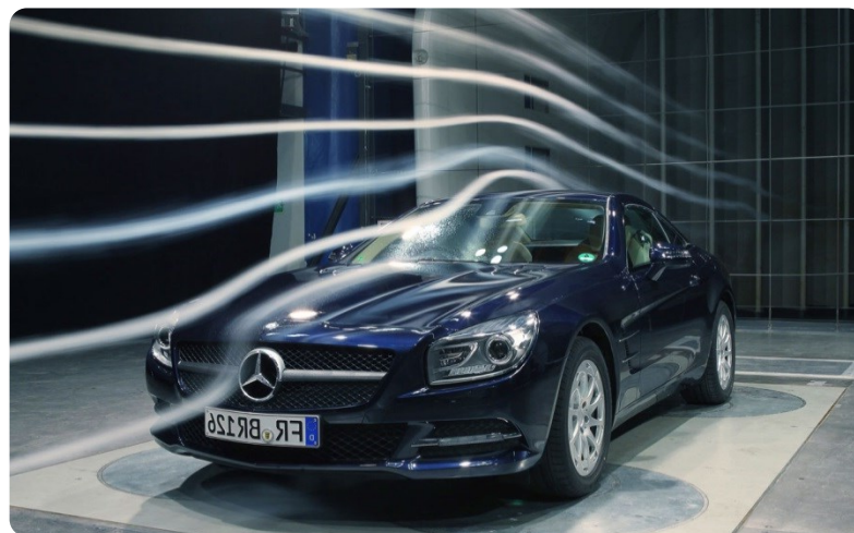
Szélcsatornában áramlás láthatóvá tétele áramvonalakkal
