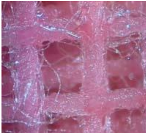
1.4 ábra: K&N gyártmányú légszűrő lamelláit alkotó elemi szálakból szőtt anyag nagyított képe [3]
