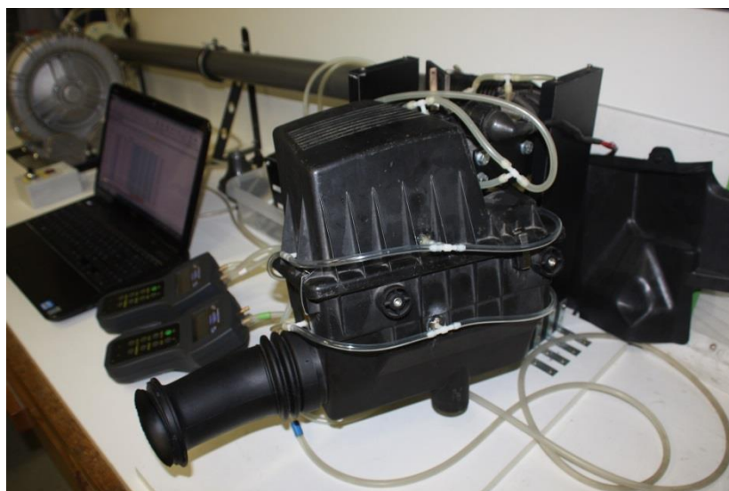
2.9 ábra: A légszűrőház egyes megcsapolási pontjai a statikus nyomás méréséhez
