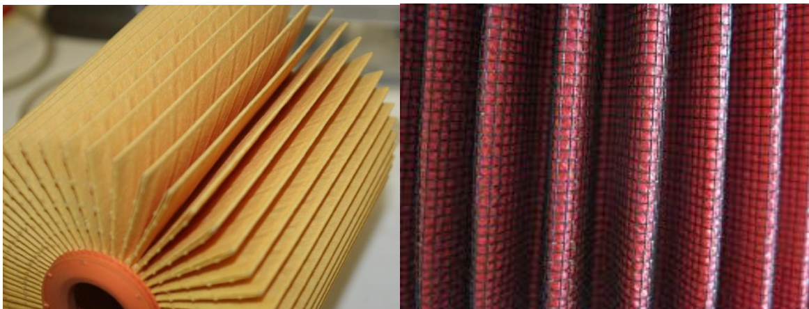
3.1 ábra: Szerkezeteti eltérés a Bosch (és az össze többi), illetve a K&N gyártmányú légszűrő között
