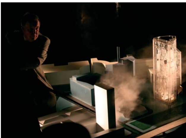
16. ábra: A Nyugdíjbiztosító épület és a Rendőrpalota árbc modellje mögött kialakuló leválási buborék „felemeli” az utcaszinten kibocsátott szennyezőt
