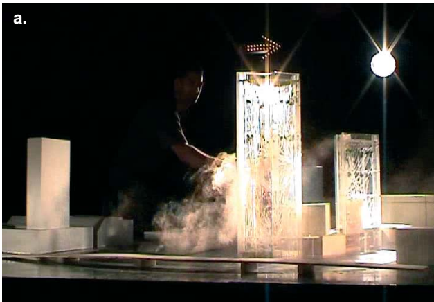
15. ábra: Az épület széllel szembe forduló homlokzatának alsó részén a magasból tisztább levegő áramlik le (az olajkőd bevezetés az a. képen alacsonyabban, a b. képen magasabban)
