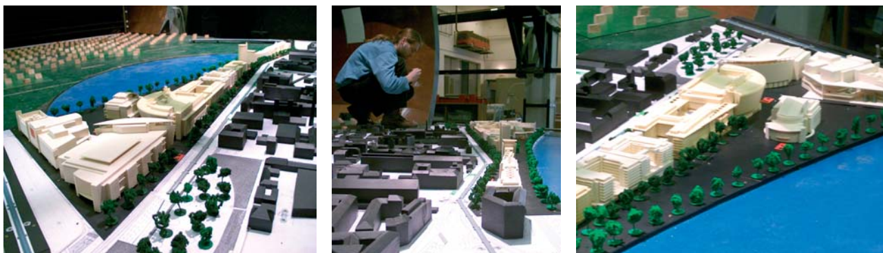
13. ábra: A növényzet modellezése a szélcsatornában
