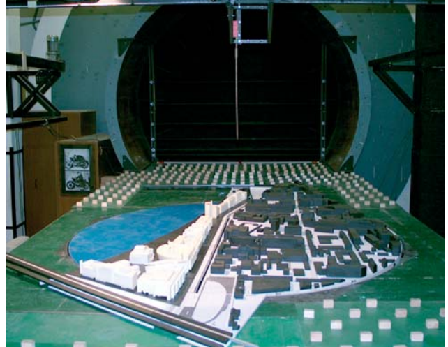
5. ábra: A Millenniumi Városközpont vizsgálata a szélcsatornában
