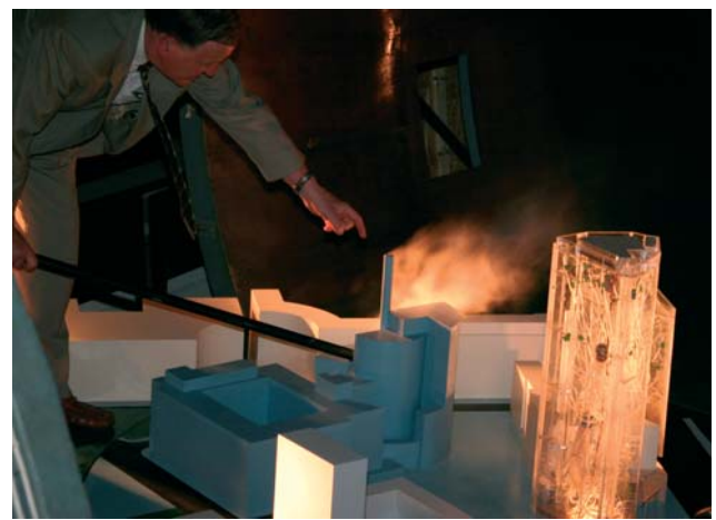
16. ábra: A Nyugdíjbiztosító épület és a Rendőrpalota árbc modellje mögött kialakuló leválási buborék „felemeli” az utcaszinten kibocsátott szennyezőt
