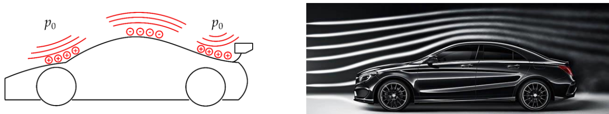
2.14. ábra. Autó karosszériáján kialakuló nyomáseloszlás [5].
