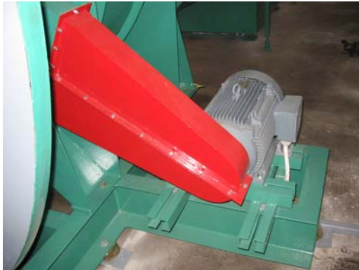
5.4. ábra. Az Áramlástan Tanszék által kifejlesztett szélcsatorna-ventilátor járókereke (félgömb orrkúp, profilos lapátozás) és utóterelő-lapátozása (profilos lapátozás); ékszíjhajtás
