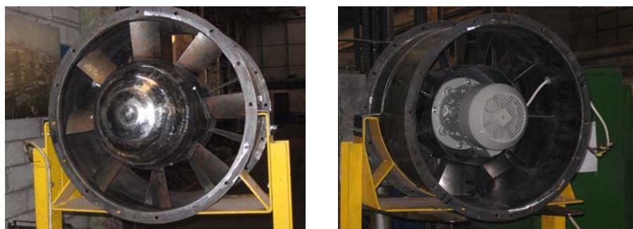
5.2. ábra. Az Áramlástan Tanszék által kifejlesztett nagy vetőtávolságú axiálventilátor prototípusa félgömb alakú orrkúppal, elől- és hátulnézetben (közvetlen hajtás, utóterelő)
