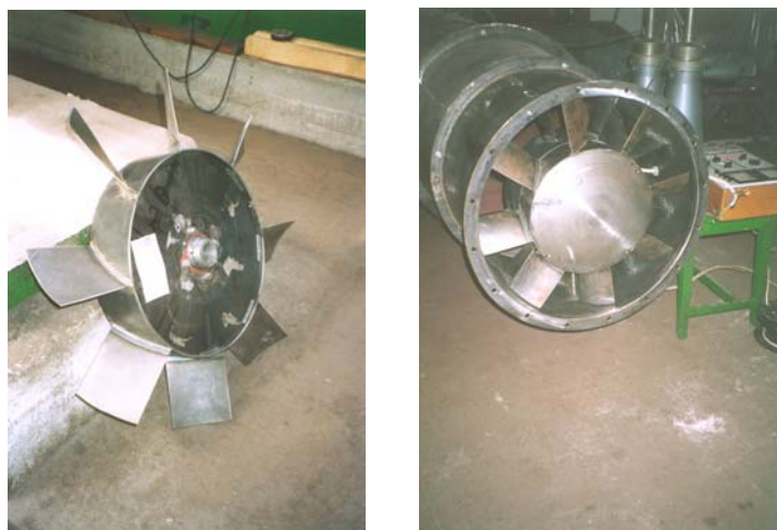
5.1. ábra. Az Áramlástan Tanszék által kifejlesztett nagy vetőtávolságú axiálventilátor prototípusa lemezlapátos járókerékkel és tompa aggyal
